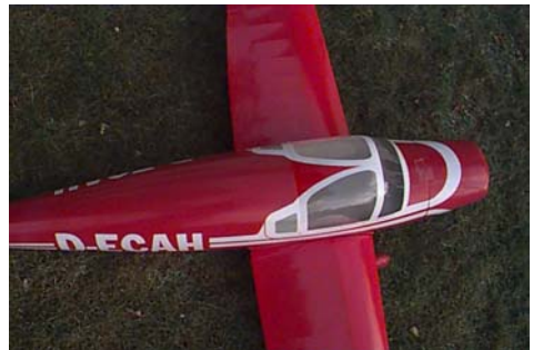
Das oben erkennbare weiße Dekor liegt dem Bausatz bei. Unterhalb der Tragfläche ist die Steckung für das zum Transport abnehmbare Hauptfahrwerk.
