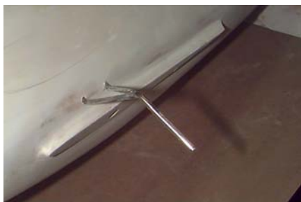
Das oben erkennbare weiße Dekor liegt dem Bausatz bei. Unterhalb der Tragfläche ist die Steckung für das zum Transport abnehmbare Hauptfahrwerk.
