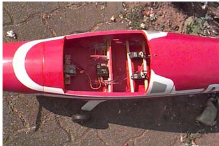
Servoeinbau mit 2 Standard Servos für Höhe und Seite, Der Akkupack ragt in die Motorhaube hinein Dazwischen ist die Steckung für das Fahrwerk erkennbar
