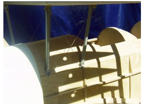
Höhenleitwerk Mit Zwischenrippen
