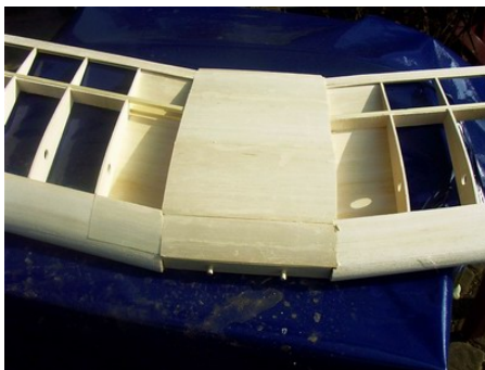
Untere Tragfläche mit Dübeln
