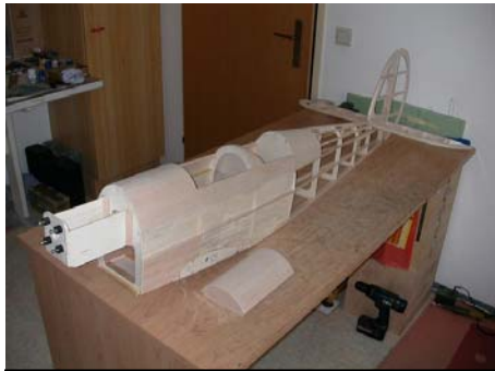
Rumpfbau mit Motorträger
