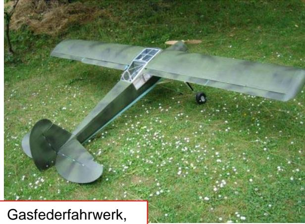
Fertig aufgebaut mit Gasfederfahrwerk, Streben und Ruder-Gegengewichten
