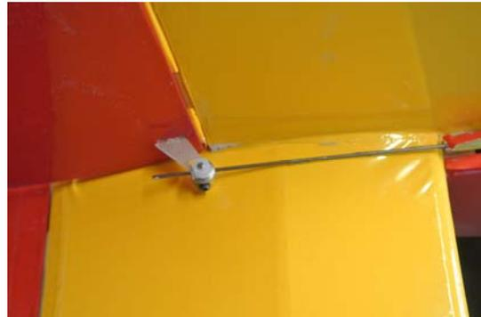
Aus dem Rumpf nach hinten herausgeführt und auf Rumpflänge abgeschnitten. Die Anschlüsse zu den Rudern bleiben zunächst unbearbeitet und werden nach Aufkleben des Höhenruders auf den Rumpf genau abgelängt und mit den Anschlüssen konfektioniert.
