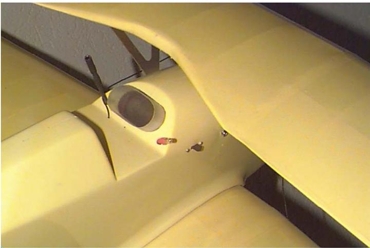
**Akkuschacht im Rumpf bis zur Vorderkante der unteren Tragfläche einsetzen. Schacht überstehen lassen, um den Akku mit Klebefilm gegen herausrutschen daran zu sichern. Die seitlich herausschauenden Kabel kommen vom Regler, der in einer Linie oben im Rumpfrücken hinter dem Motor liegt.**
